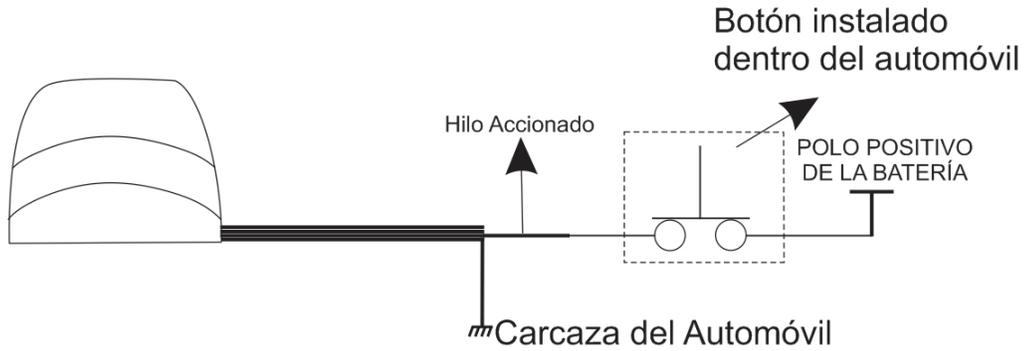
El cable accionado que va para el botón instalado dentro del automóvil puede ser rojo (tecla 1) o amarillo (tecla 3).
